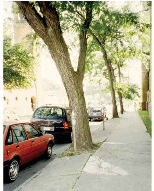
Fig. 1.10 Soulèvement du trottoir causé par la croissance de racines superficielles à Ithaca, NY
