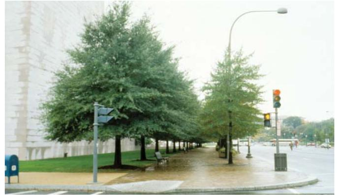
Fig.1.6 Cette photo montre l'effet du volume de sol disponible sur la croissance des arbres. Ces chênes ont été plantés au même moment; à droite dans des fosses standards et à gauche dans un milieu ouvert.
