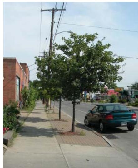
Fig. 1.24 Pavé de béton sur un lit de pose en sable grossier ou petites pierres calibrés en surface d'une fosse continue de CU-Sol Structural<sup>MD</sup> à Ithaca, NY
