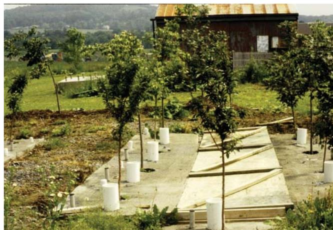
Fig 1.26 Étude de comparaison sur trois ans entre des arbres plantés en trottoirs et les mêmes dans le CU-Sol Structural<sup>MD</sup>. Les espèces étaient des érables, des tilleuls et des aubépines.
