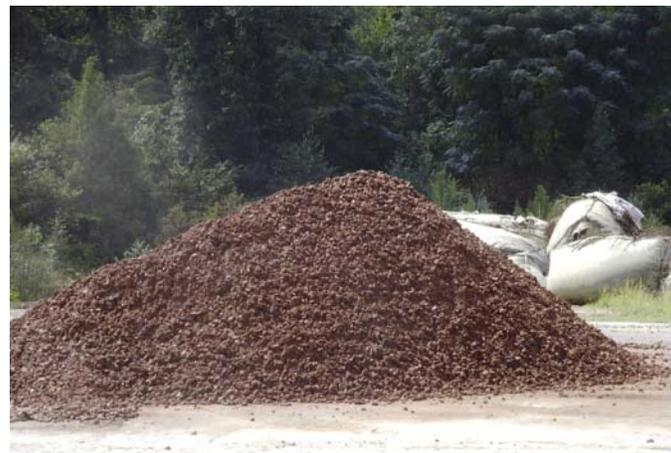
Fig. 1.8 Dans le sens des aiguilles d'une montre : pierre concassée calibrée uniformément ¾" – 1 ½", en pile et en vue rapprochée. Un sol argileux. Le CU-Sol Structural<sup>MD</sup> produit fini.
