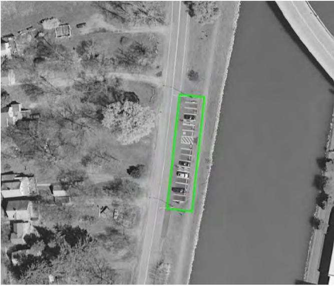
L'aire de 150 pi x 18 pi fut divisée en deux parties : la partie sud fut construite en utilisant un asphalte poreux de 3 po et la partie nord fut construite en utilisant une couche d'asphalte imperméable traditionnel. La surface entière fut excavée jusqu'à une profondeur de 2 pi et remplacée par une nouvelle couche de base de CU-Sol Structural<sup>MD</sup>.
